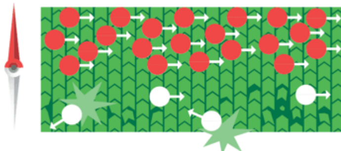
En un conductor magnetizado la dirección de los espines de la mayoría de los electrones es paralela a la dirección de magnetización (rojos). Una minoría de electrones tiene spin orientado en sentido contrario (blancos). En este ejemplo los electrones con spin antiparalelo son más fuertemente dispersados.
