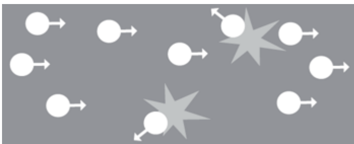
La resistencia eléctrica de un conductor es debida a los choques de los electrones contra irregularidades del material lo cual dificulta su avance.
