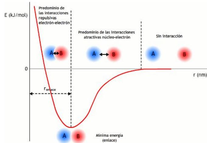
A medida que se acercan A y B las interacciones atractivas entre los núcleos y electrones son predominantes. **La energía del sistema disminuye, ganando en estabilidad**, y tienden a acercarse uno a otro, pero a partir de determinada distancia las interacciones repulsivas entre los electrones (también entre los núcleos) se vuelven más importantes, con lo cual **se produce una aumento de la energía del sistema, lo que le hace perder estabilidad** y tienden a separarse.
