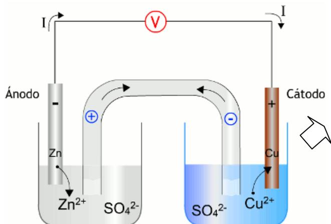
En el vaso de la izquierda (**ánodo**) se introduce un electrodo de cinc en una disolución de ZnSO<sub>4</sub> produciéndose la oxidación de Zn a Zn<sup>2+</sup>
