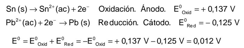
**Producir una reacción química a partir de una corriente eléctrica, también es posible.** Para ello sólo hay que lograr que una corriente eléctrica (continua) pase a través de una sal fundida o una disolución acuosa de un electrolito. **La corriente eléctrica produce entonces en ambos electrodos reacciones de oxidación y reducción y el proceso se conoce con el nombre de electrolisis.**
