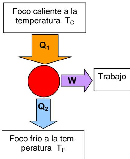
**Esquema de una máquina térmica (simbolizada por el círculo rojo) que cumple el Segundo Principio de la Termodinámica.**
