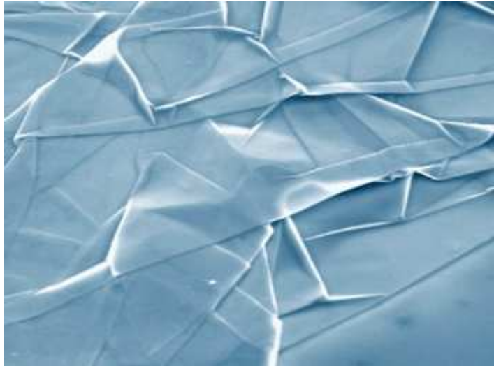
Figura 3. Como una lámina de seda. Pliegues de una lámina de grafeno sobre una superficie de silicio. La imagen se obtuvo con un microscopio electrónico y está ampliada cerca de 5 000 veces.
