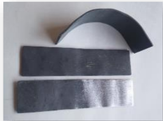
Láminas de plomo mostrando su facilidad para ser doblado y el color gris oscuro cuando está oxidado, contrastando con el gris claro del metal.
