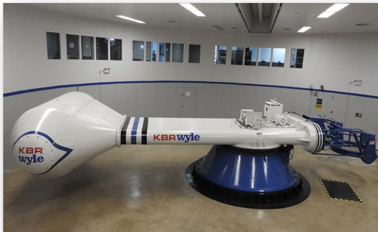
Centrífuga Brooks Puede operar a 30 g Fuente: http:// www.halldale.com
