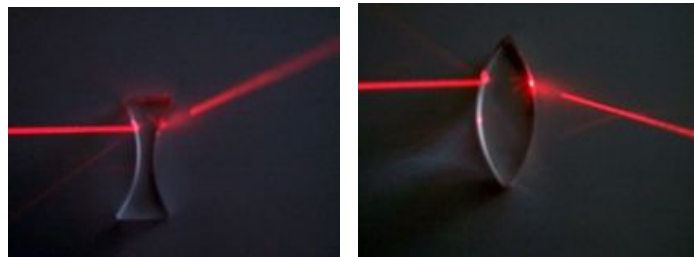
Izquierda: lente divergente (bicóncava) Derecha: lente convergente (biconvexa)
