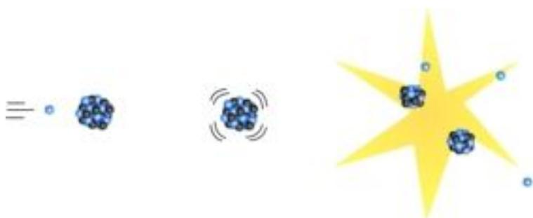
Esquema de la fisión inducida de un núcleo:
